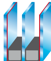
3-fach Isolierglas mit zwei unsichtbaren Wärmedämmbeschichtungen aus Edelmetall.
