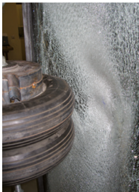
Dopo rimbalzo standard da 100 mm di altezza
